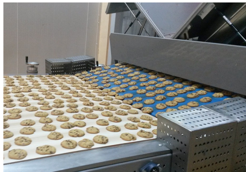
De niet-behandelde toplaag van deze frictieaangedreven weefselband bestaat uit pvc of TPU
